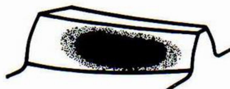
Mittleres Tragbild am inneren Zahnende auf der Zahnunterseite
