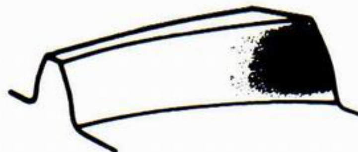
Tragbild am äußeren Zahnende auf der Zahnoberseite
