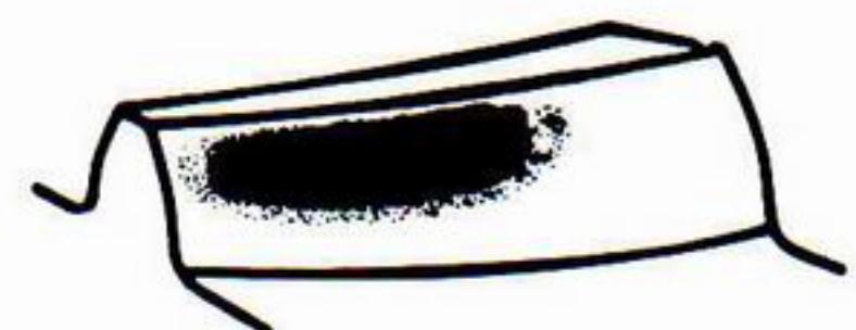
Mittleres Tragbild am inneren Zahnende auf der Zahnoberseite
