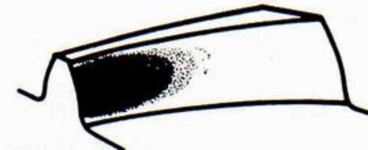
Tragbild am inneren Zahnende auf der Zahnoberseite
