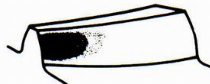
Tragbild am inneren Zahnende auf der Zahnoberseite
