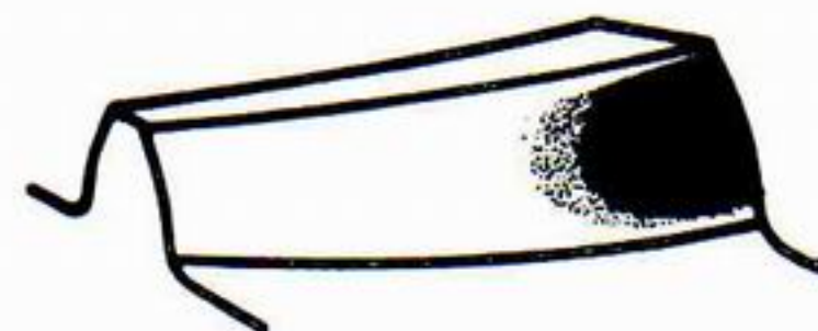
Tragbild am äußeren Zahnende auf der Zahnoberseite
